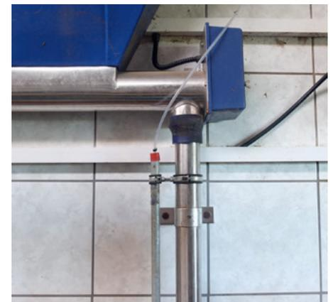
*Über einen Kunststoffschlauch wird die Atemluft angesaugt, während die Kuh frisst. Die Atemluft wird in die Snifferbox geleitet und dort analysiert.*
