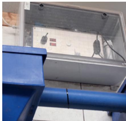
*Die Snifferbox ist ein Gaschromatograph, der hoch über dem Melkstand hängt. Er ist das Herz der Methanmessung im Melkstand.*
